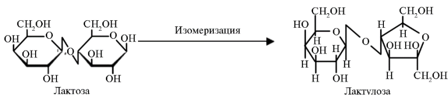
Рис. 2. Схема процесса изомеризации образования лактулозы (20).
