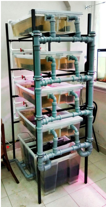
Рис. 1. Многоярусная установка замкнутого водоснабжения, которую использовали для выращивания молоди австралийского красноклешневого рака ( Cherax quadricarinatus ).
