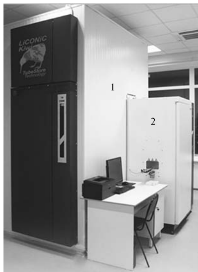
Рис. 1. Внешний вид станции низкотемпературного автоматизированного хранения биологических образцов («Liconic Instruments», Лихтенштейн): 1 — камера хранения, 2 — передаточный комплекс.
