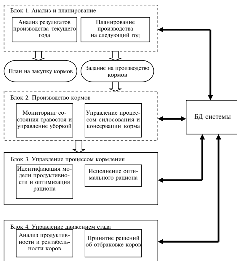
Рис. 5. Блок-схема автоматизированной системы производства молока.
